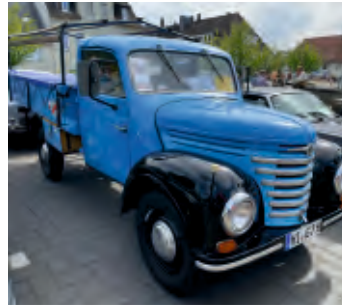
Barkas V 901/2 – Ein Kleinlastwagen aus der ehemaligen DDR mit 3-Zylinder Zweitakter und 28 PS.
