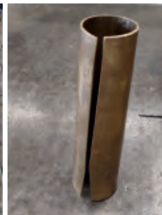
Mehrfach gewalzte und geglähte Messing-Hülse für die ausgeschlagene Vorderachse.
