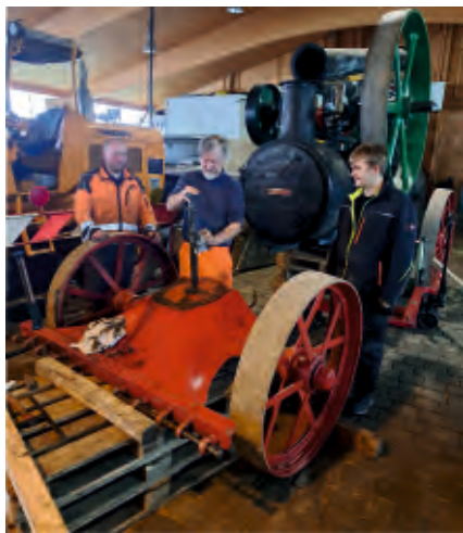
Schadensfeststellung am demontierten Drehschemel.
